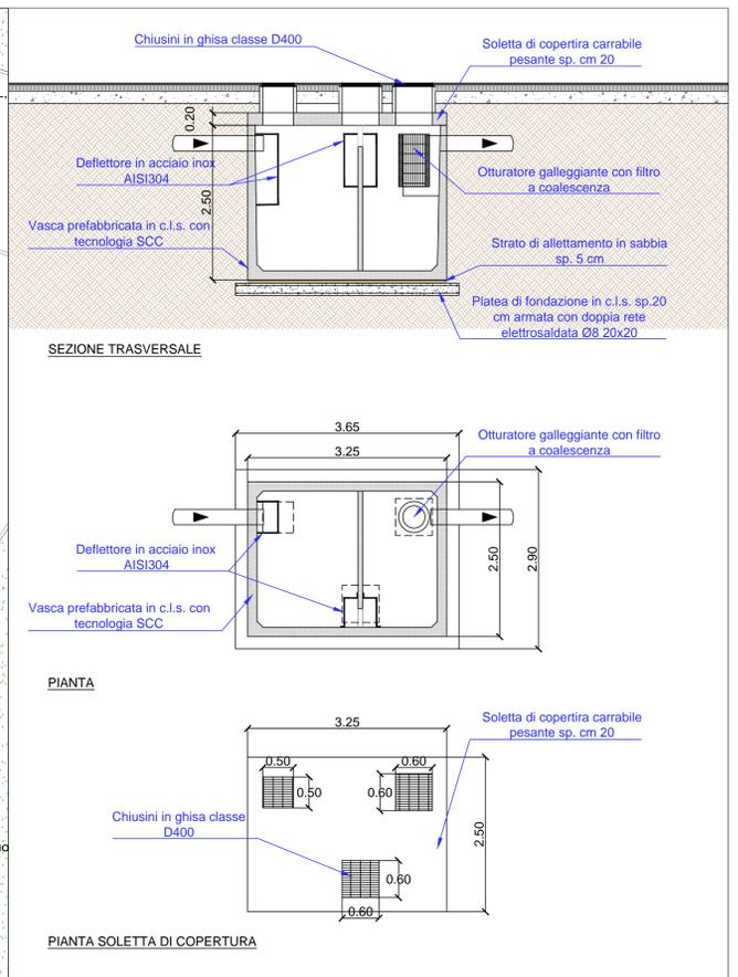
DETTAGLIO DISOLEATORE DISSABBATORE - scala 1:50
